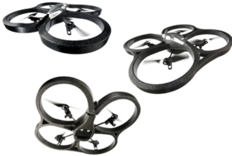
Figura 2.2: Foto de um AR.Drone, quadricóptero de lazer desenvolvido pela Parrot S.A. (Extraído de [1])
