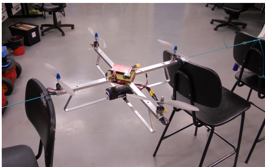
Figura 4.9: Montagem utilizada para tuning do PID
